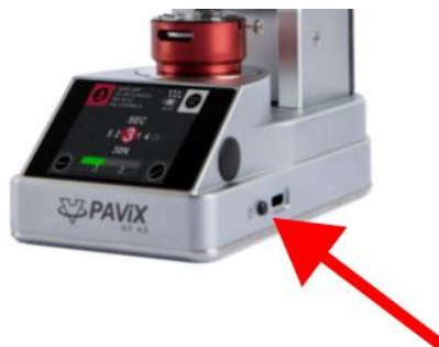
Figure 13: Démarrage PAViX - pression bouton à droite
