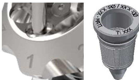
Figure 10: Tasseau convenablement positionné dans le barillet, position 1 / tasseau
